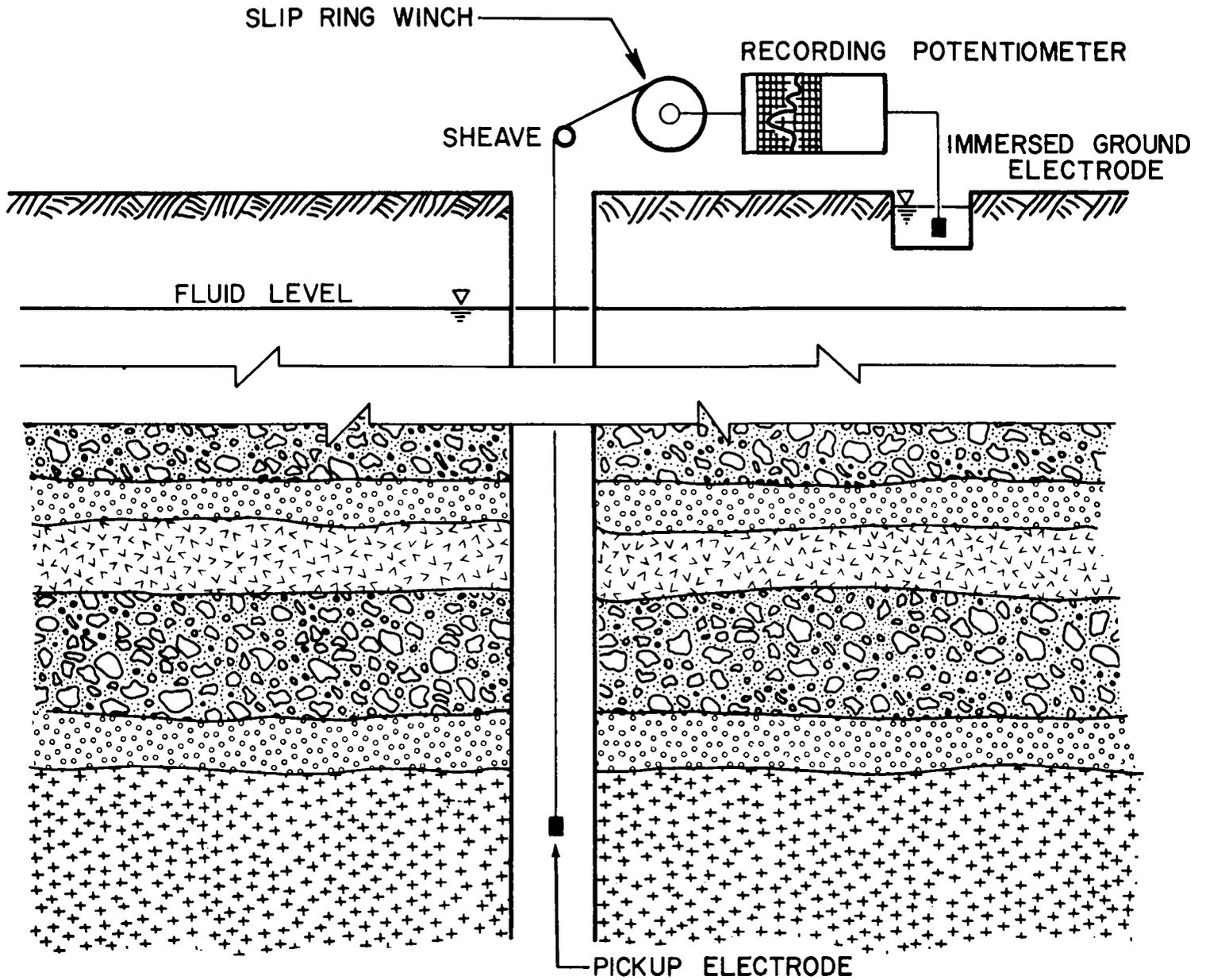
FIGURE 2. CIRCUIT FOR RECORDING SPONTANEOUS POTENTIAL.
