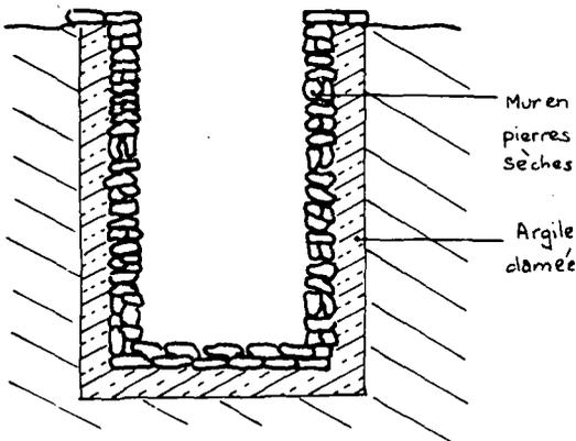
Un type de construction qui n'utilise que des matériaux locaux : de l'argile et des pierres.
