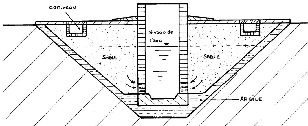
La dalle inférieure reçoit ensuite une dalle à cavité arrondie (pierre dure ou béton) capable de résister aux chocs répétés des seaux et dont le pourtour sert de fondation pour élever un mur.
