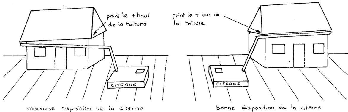
Si la toiture n'est pas de niveau, l'implantation judicieuse de la citerne facilite la pose de gouttières.
