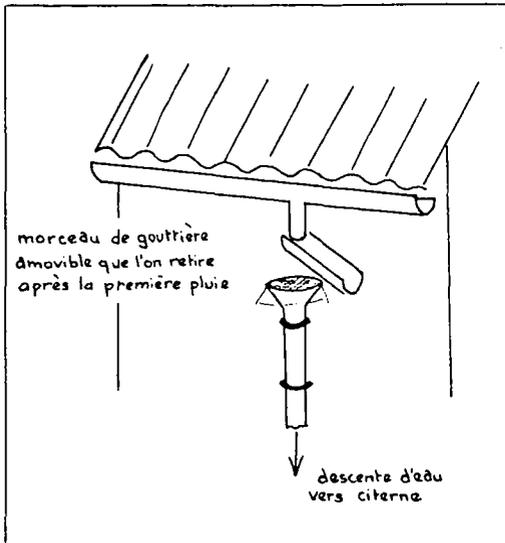
Le système le plus simple et finalement le plus fiable : un simple morceau de gouttière que l'on retire après la première pluie de lavage de la toiture.
