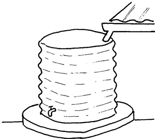
Les citernes surélevées peuvent atteindre des capacités de 10 m<sup>3</sup>. Les tôles sont assemblées par rivetage ou par une soudure appropriée, ce qui nécessite des artisans qualifiés et un peu d'équipement.
