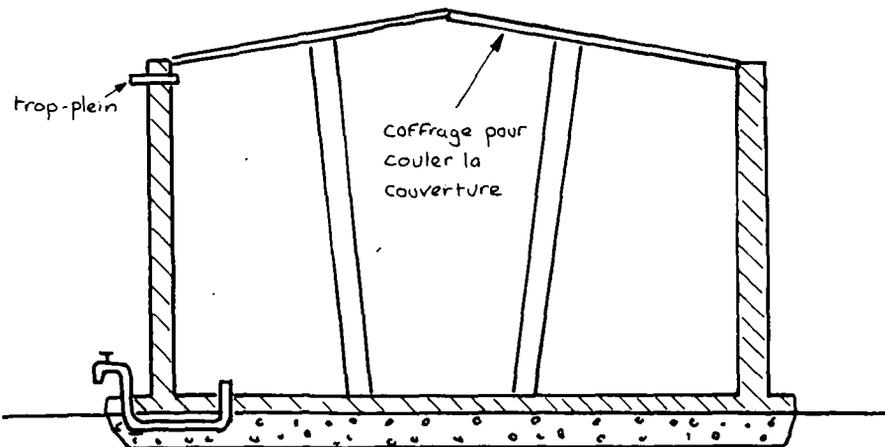
Un mortier de 5 cm est coulé au sol. Il ne nécessite pas de renforcement si le sol est jugé stable.
