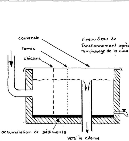
La première pluie remplit d'abord le bac de décantation, où l'eau est freinée par une chicane, filtrée grossièrement par une toile à tamis. Lorsque le bac est plein, l'eau s'écoule dans la citerne par le tuyau de trop-plein vertical.
