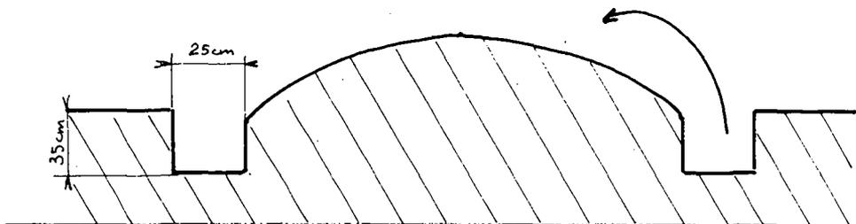
On recouvre le dôme d'une couche de mortier de 10 mm d'épaisseur.
