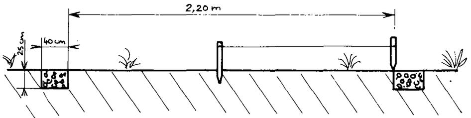
Après 48 h., cet anneau va permettre d'effectuer le terrassement de la citerne avec précision, il évitera aussi l'éboulement de la bouche du cylindre. Il servira également de fondation aux parpaings qui surélèveront la citerne et la mettront à l'abri du ruissellement des eaux de surface.
