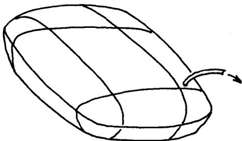
Ces réservoirs sont repliables pour le transport.
