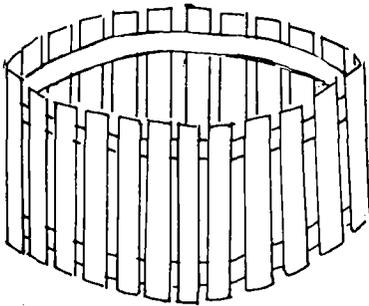
Un moule en planches peut également être construit.
