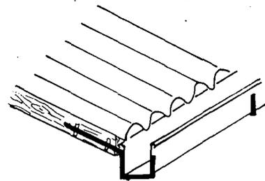
support de gouttière en fer à béton
