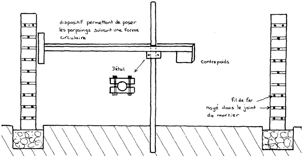
Pour des réservoirs de grand diamètre (4 m et plus), on peut éviter d'utiliser le béton armé en faisant une maçonnerie armée. Entre chaque rangée de briques, on étire du fil de fer barbelé (1 ou 2 rangées) noyé dans le mortier du joint.
