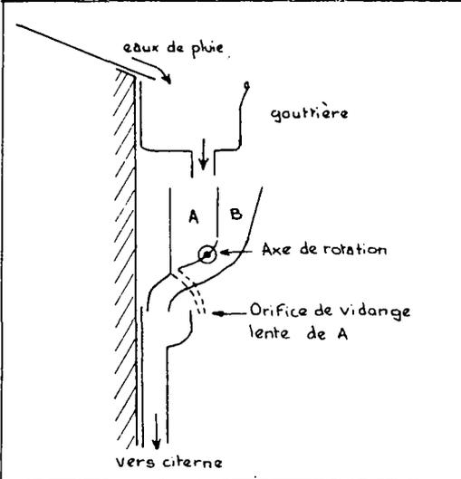
Ce système australien est original mais un peu complexe à fabriquer. La partie principale est un entonnoir pivotant, divisé en deux chambres A et B. En position initiale, les eaux de pluie se déversent dans A. L'eau s'accumule dans A (car l'orifice de vidange est très petit), l'entonnoir bascule déséquilibré par le poids de l'eau. L'eau de pluie se déverse alors dans B pour être amenée dans la citerne.
