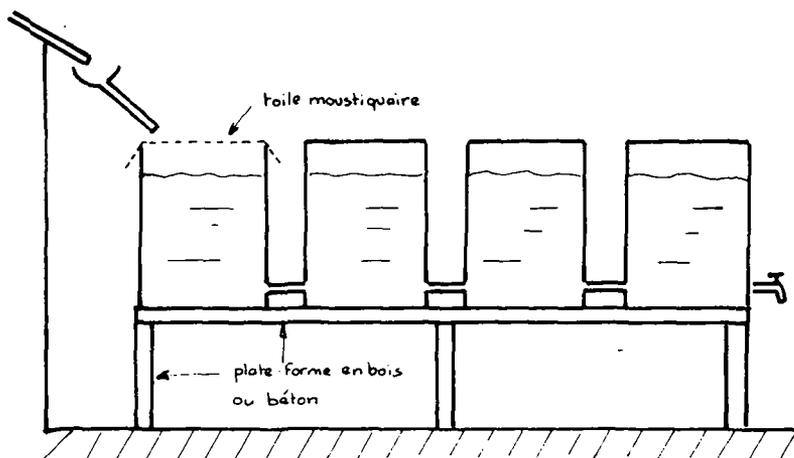
Les fûts de 200 l apportent une solution rapide au problème de stockage. Ils demandent à être nettoyés parfaitement avant usage. Une peinture de protection (non toxique) aussi bien à l'intérieur qu'à l'extérieur les protégera de la corrosion. La soudure des tuyaux de raccord est délicate car la tôle est très fine.
