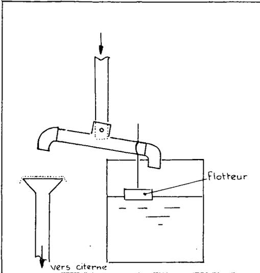
La descente d'eau débouche sur une double sortie basculante commandée par un flotteur. La première pluie d'eau sale remplit d'abord le fût. Lorsque celui-ci est plein, le flotteur en s'élevant oriente l'eau dans la conduite menant à la citerne. Cette conduite est protégée par une toile à tamis.
