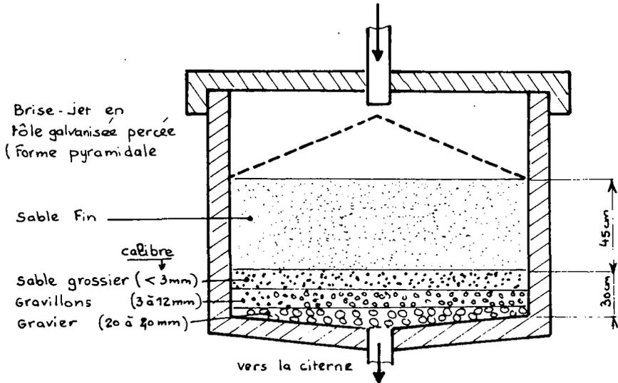
Les particules en suspension dans l'eau vont être retenues lors du passage dans le sable et vont au fur et à mesure de l'utilisation du filtre, remplir les vides laissés entre les grains de sable.
