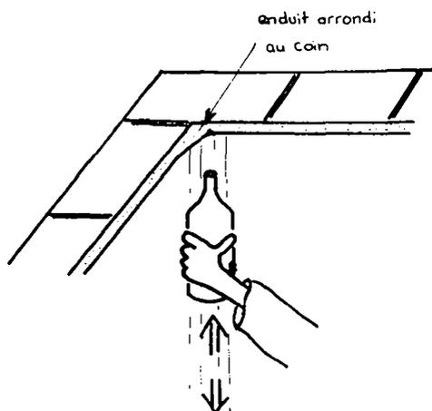
Les angles ne seront pas fait d'équerre mais avec un bel arrondi. On obtient de belles gorges dans les coins en utilisant le corps d'une bouteille pour lisser.
