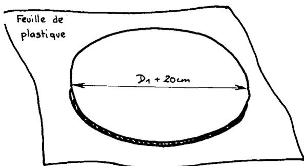
On fait un disque de mortier de 2 cm d'épaisseur et de diamètre  $D_1 + 20\text{ cm}$
