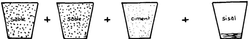
2 mesures de sable fin + 1 mesure de ciment + 1/10 mesure de sisal
