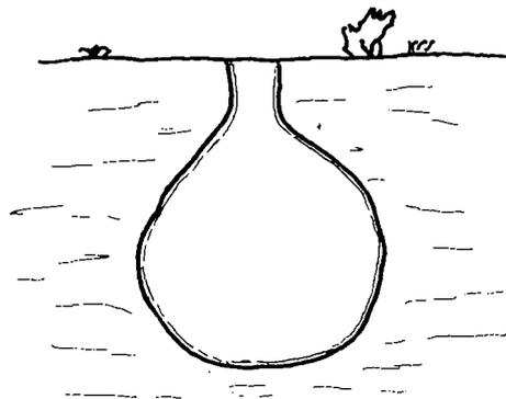
Citerne creusée en forme de bouteille (analogue aux citernes palestiniennes de Gezer), imperméabilisée par un enduit appliqué sur les parois.
