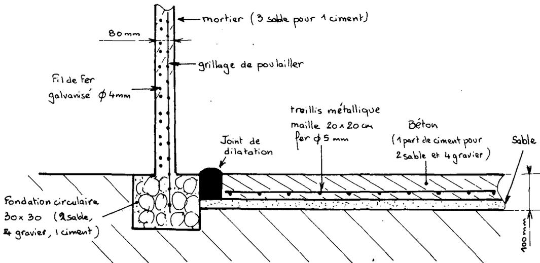
Avant de couler la base, on réserve l'espace du joint de dilatation avec un matériau que l'on pourra extraire facilement (polystyrène expansé, carton ...).
