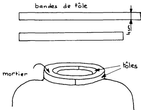
Fabriquer un couvercle à l'aide des 2 bandes de tôle.
