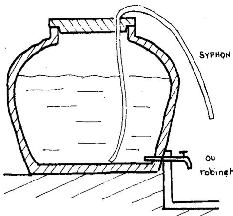
Pour retirer l'eau de la jarre sans avoir à soulever le couvercle fréquemment, ce qui peut être une cause de contamination de l'eau, on peut prévoir le passage d'un tuyau souple pour syphonner ou sceller un robinet à la base de la jarre.
