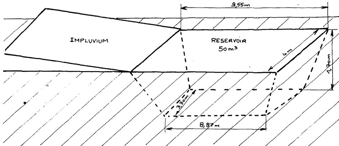
C'est un réservoir enterré, pour le stockage d'eau destinée à des usages agricoles ou artisanaux (pas pour l'eau de boisson!). Il peut être alimenté par une toiture ou par un impluvium construit à cet effet.
