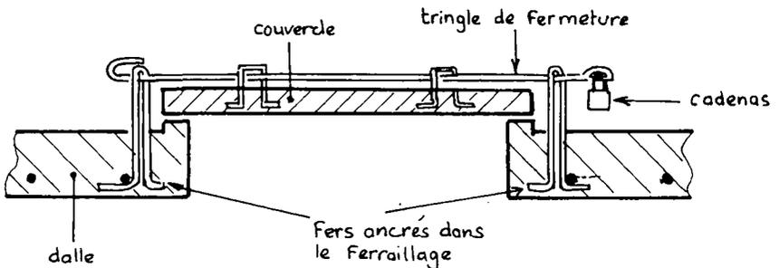
Deux boucles de fer liées au ferrailage de la dalle peuvent être prévues pour permettre la fermeture du couvercle (identique au système de fermeture des cantines métalliques).
