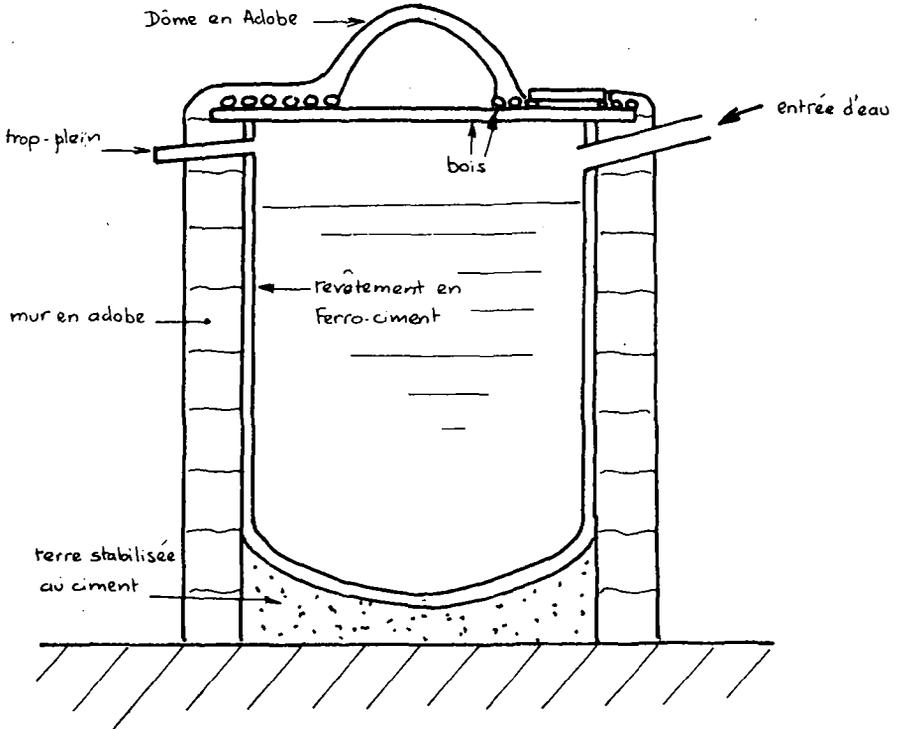
Au Mali, les Dogons construisent traditionnellement des silos à grain en adobe (briques de terre crue séchées au soleil).
