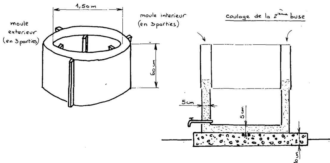
Une base de fondation de 10 cm est préparée séparément. Une couche de mortier de 5 cm d'épaisseur est coulée sur la base durcie juste avant de couler la 1ère buse.
