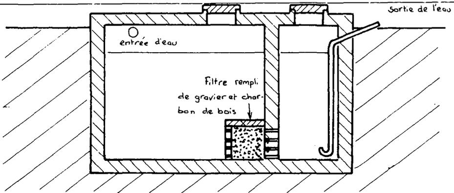
C'est une citerne à 2 chambres. L'eau se déverse dans le premier compartiment où elle se sédimente. Pour transiter dans le deuxième compartiment, elle doit traverser un filtre. Le contenu du filtre est changé tous les 4 à 6 ans lorsqu'il est bouché par les impuretés. Ceci doit se faire lorsque la citerne est sèche.
