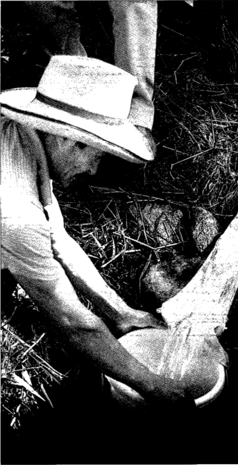
Aforo del caudal de agua (método volumétrico)
