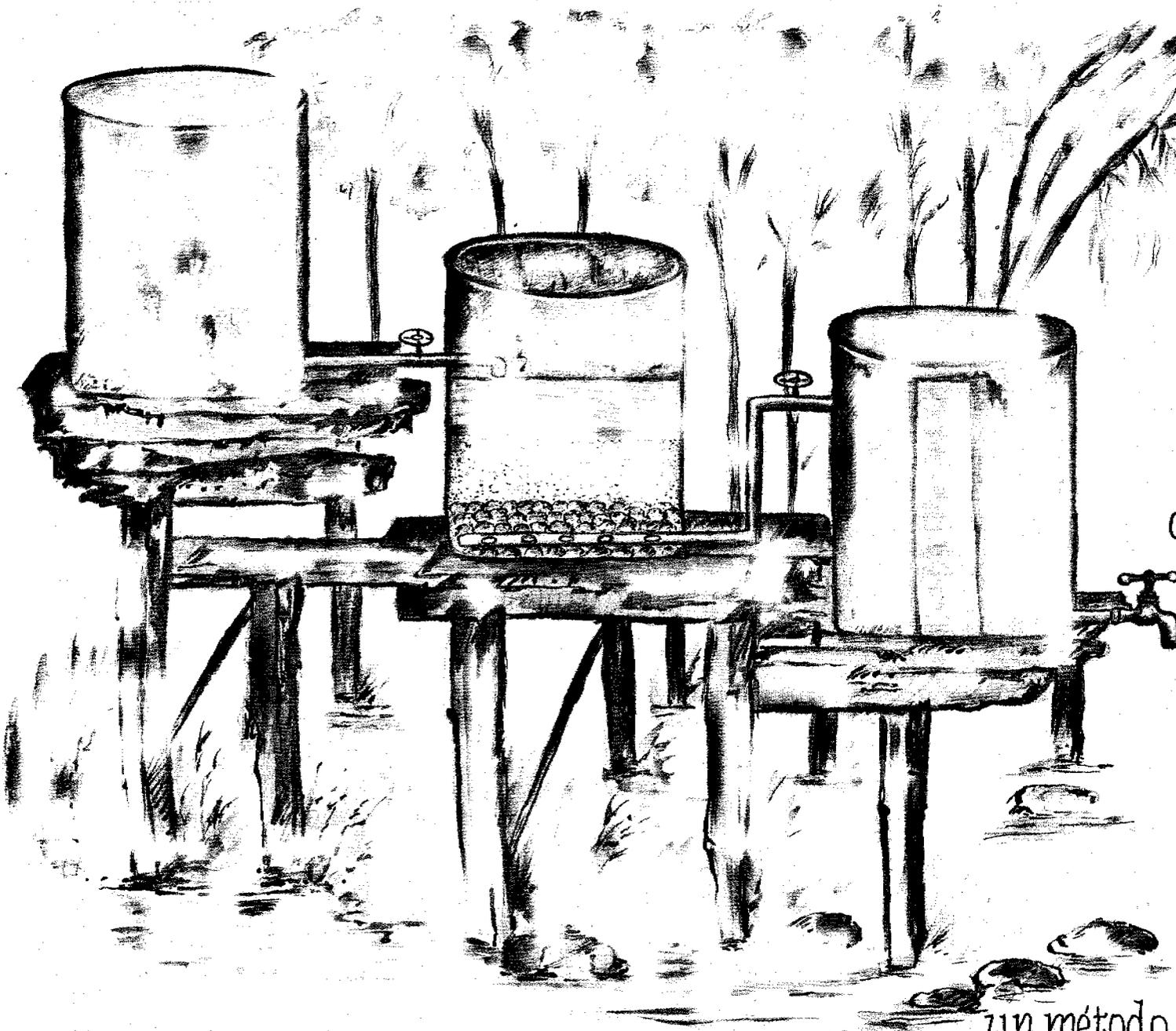
El agua también puede mejorarse en casa utilizando un pequeño filtro de arena por el que el agua penetre lentamente. El agua resultante de la filtración es de mejor calidad para el uso que el agua cruda. Tres tanques son suficientes para construir este sistema: Uno para recoger el agua, el otro para filtrarla y el último, que debe permanecer cubierto, para almacenarla.
