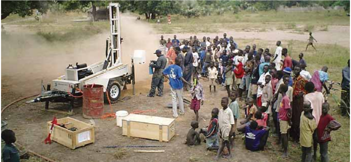
Uma sonda portátil com capacidade para fazer DTH
